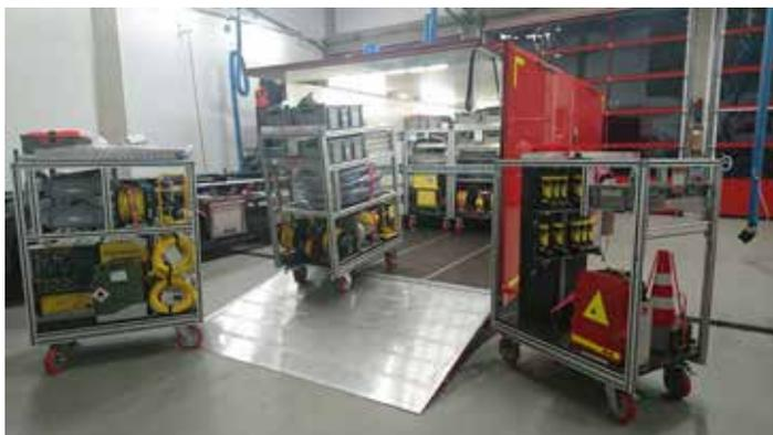
Die komplette Beladung besteht aus 11 Rollcontainern mit je drei gleichen Modulen. Darin enthalten sind 18 Pumpen, Stromerzeuger und Kabel, Schwimmwesten, Schaufeln, Besen, Licht, Funkgeräte und Handlampen.
