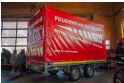
Der Mehrzweckanhänger wurde in Eigenregie von den Feuerwehrleuten in rund 220 Arbeitsstunden gebaut. Er dient zur Bewältigung von Hochwassereinsätzen und zur Bekämpfung von Ölschäden. Man habe
