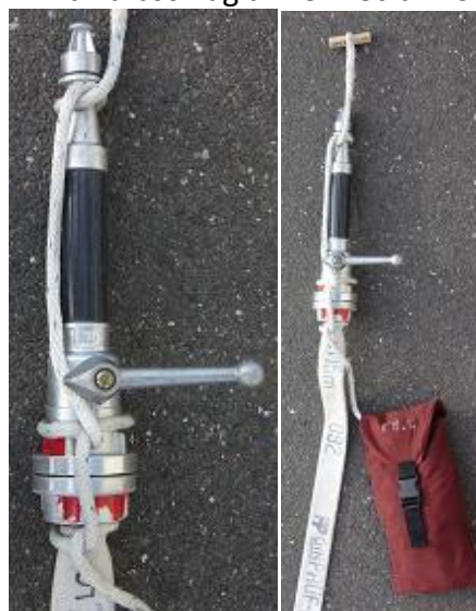
Bild 7 + 8: Mastwurf mit Halbschlag am CM-Strahlrohr mit Schlauch
