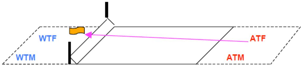
Das Übungsfeld ist 7 m lang und 1,5 m breit – das Arbeitsfeld 4 m lang und 1,5 m breit. Der Böschungswinkel wird mittels einer schrägen Holzschalung (0,50 lang – 0,30 hoch) angedeutet.
