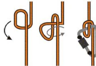
Bild 6: Mastwurf an der Tragkraftspritze
