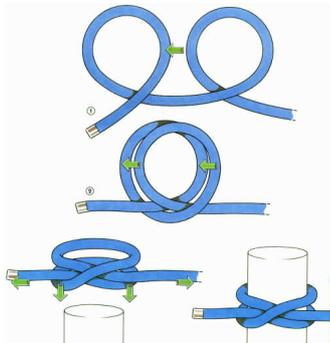
Bild 7 + 8: Mastwurf mit Halbschlag am CM-Strahlrohr mit Schlauch
