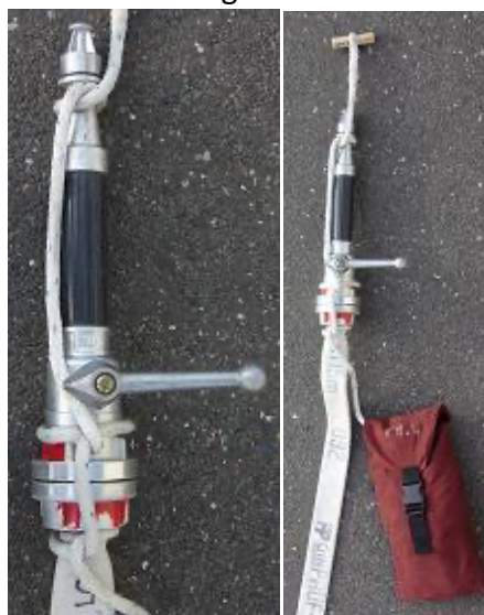
Bild 7 + 8: Mastwurf mit Halbschlag am CM-Strahlrohr mit Schlauch
