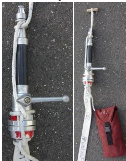
Bild 7 + 8: Mastwurf mit Halbschlag am CM-Strahlrohr mit Schlauch
