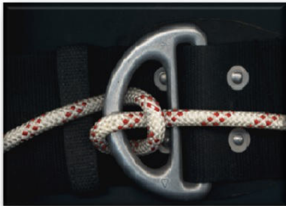
Bild 5: Halbmastwurf an der Öse
