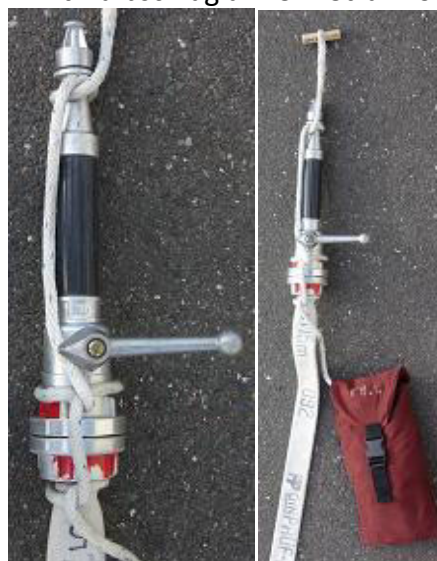
Bild 7 + 8: Mastwurf mit Halbschlag am CM-Strahlrohr mit Schlauch
