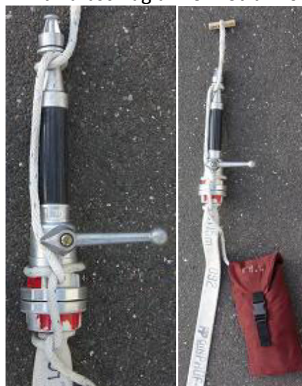
Bild 7 + 8: Mastwurf mit Halbschlag am CM-Strahlrohr mit Schlauch
