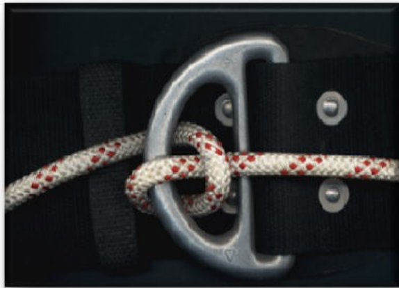
Bild 5: Halbmastwurf an der Öse
